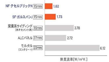
アイジーサイディングは断熱性に優れたポリイソシアヌレートフォームを採用し、他の外壁材と比較しても抜群の断熱性能を誇ります。高い断熱性で冷暖房費などの光熱費を削減でき、省エネルギーでCO2の削減に貢献します。
